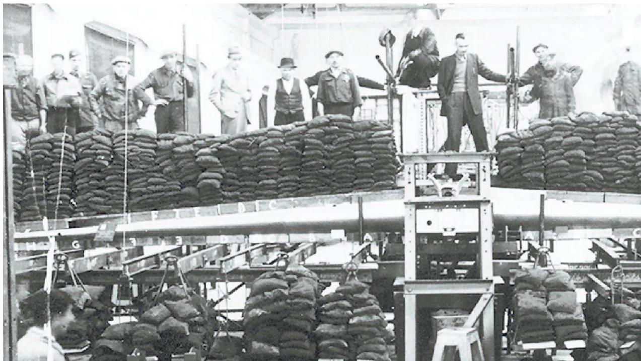
Foto di gruppo per gli operai delle Officine Reggiane durante le prove statiche delle ali di un velivolo. Gli aerei furono la produzione di punta delle Reggiane negli anni della Seconda guerra mondiale per
